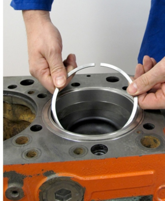
Rys. 5 – Demontaż nienaruszonych tulei cylindra
