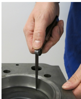
Rys. 7 – Zamykanie za pomocą szczelinomierza
