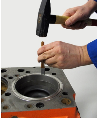
Rys. 4 – Demontaż uszkodzonych tulei cylindra
