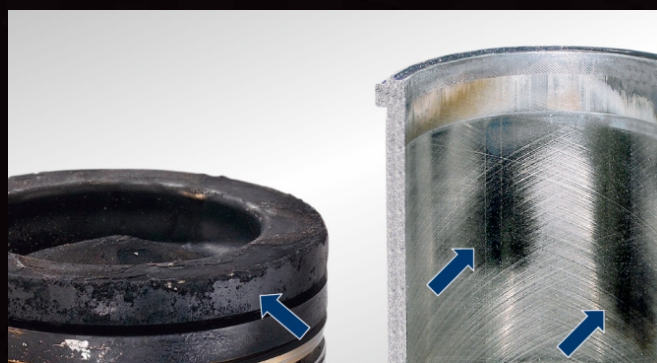
Rys. 3 - Nagar i zużycie ściernie
