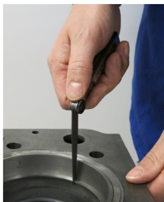
Rys. 7 – Zamykanie za pomocą szczelinomierza
