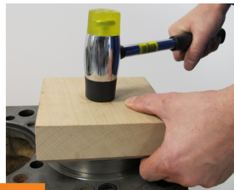
Rys. 9 – Delikatne użycie siły – wbijanie używanego pierścienia ogniowego
