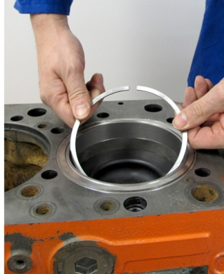
Rys. 5 – Demontaż nienaruszonych tulei cylindra
