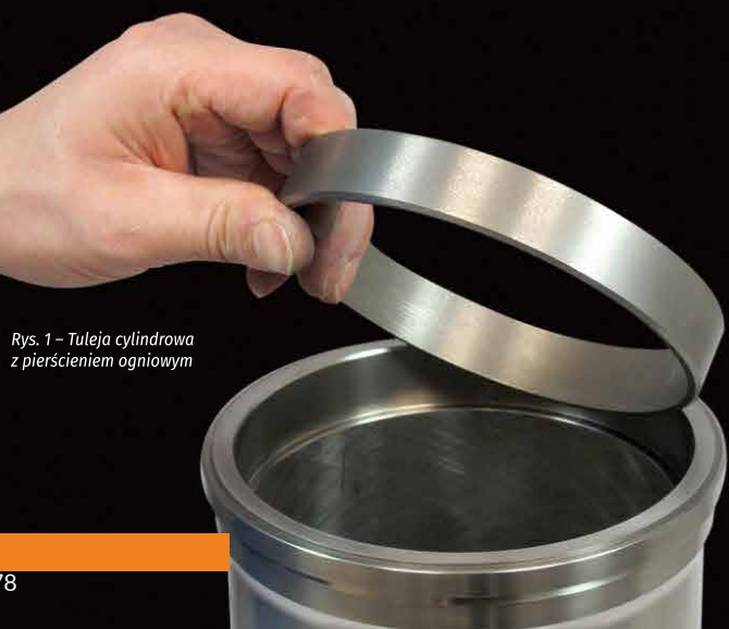
Rys. 2 - Tuleja cylindrowa z pierścieniem ogniowym
